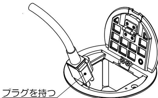
◆ 動力系コンセント、丸型引掛けコンセントのシリーズをご使用時は、プレートフタを開けた状態でご使用ください。
