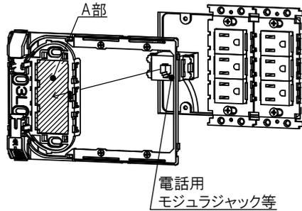
スイッチボックスを使用せず壁に取り付ける場合は、壁の厚さに合わせて市販のはさみ金具を使用してください。
