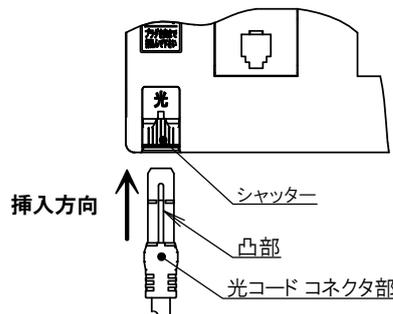
シャッターが開いた後、そのままコネクタを差し込むとSCアダプタに挿入することが出来ます。コネクタ先端に傷を付けないように、必ずカチッと音がするまで挿入してください。挿入が正常に完了すると、コネクタの凹部が青く表示されます。
