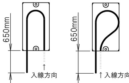
外被把持SCコネクタの再取り付けを行う場合は、表の寸法を参考に光ケーブルを切断してください。
