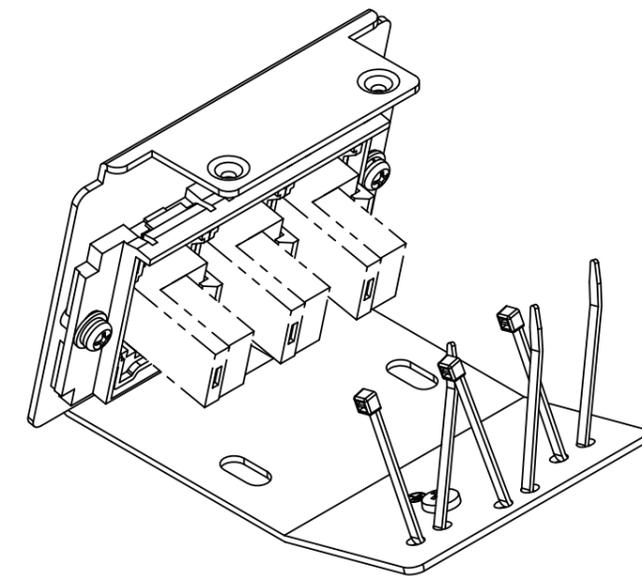
注1. 本図は実装状態を示し、⑤6極6芯モジュラジャック、⑥ダストカバーは添付品です。配線ケーブル圧接後、④JISプレート用アダプタに本図指示通り取付けて下さい。
