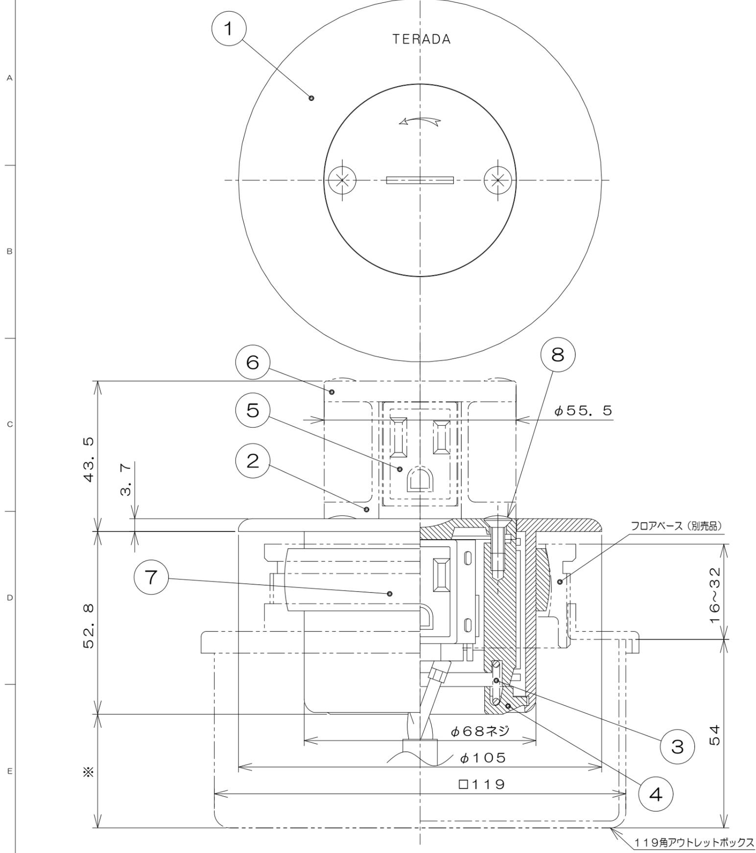
注1. 図中※印寸法は25mm以上に設置ください。
