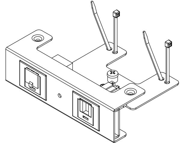
注1. 本製品のボックスへの固定には「SMA10000」に添付されているサラネジを使用します。
