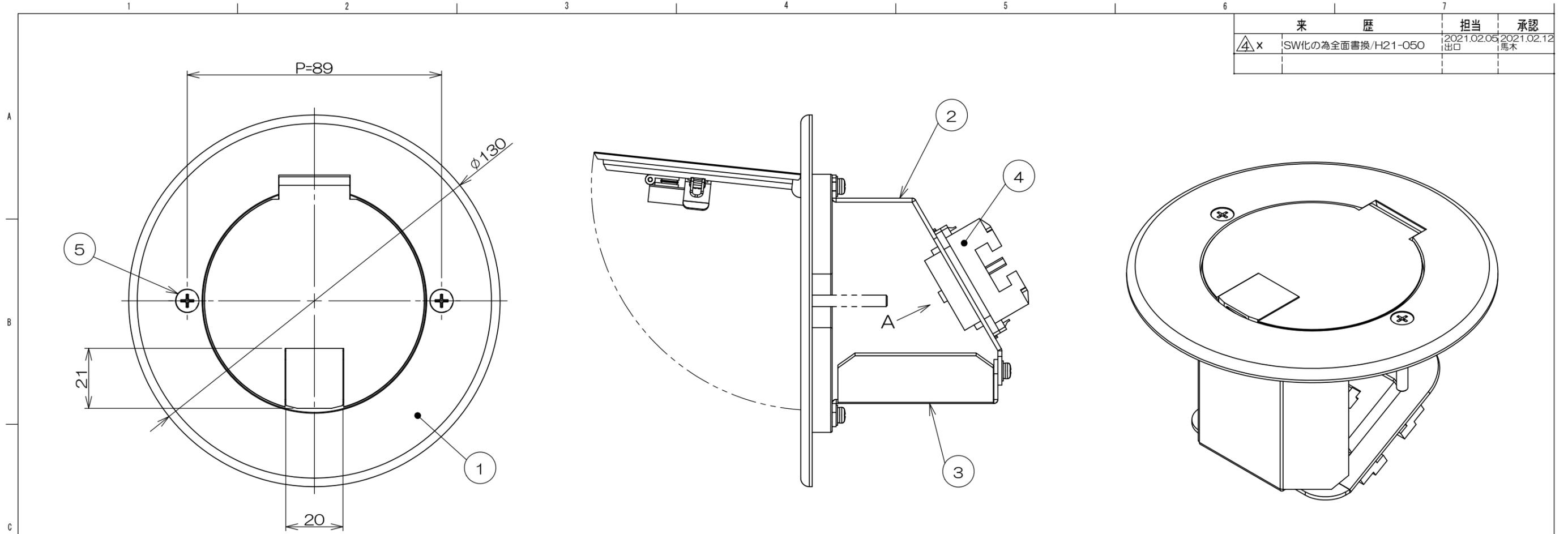
注1. 本製品の取付けには、119角深型アウトレットボックス、119角20H継棒、119角P=89大丸穴カバー塗代付の打ち込みが必要になります。
