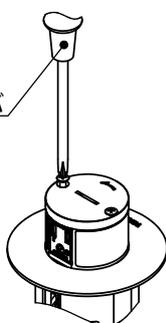
コンセントをプレート本体に収め、項目4で外したネジを使用しナカブタを固定してください。
