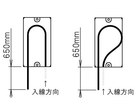
外被把持SCコネクタの再取り付けを行う場合は、表の寸法を参考に光ケーブルを切断してください。
