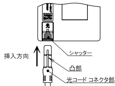
シャッターが開いた後、そのままコネクタを差し込むとSCアダプタに挿入することが出来ます。コネクタ先端に傷を付けないように、必ずカチッと音がするまで挿入してください。
