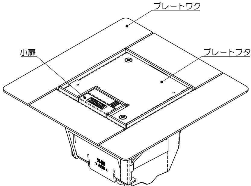
※1.設置されている状態では、本製品の上に仕上材が貼り付けられています。
